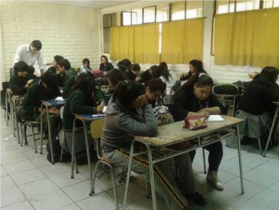
Fig. 6: Una sala de colegio técnico con máxima ocupación. El material de piso, el del mobiliario y el de los muros genera reflexión y amplificación de los ruidos producidos cuando, por ejemplo, se intenta mover (sin levantar) una mesa. Fuente: José Ignacio Díaz
